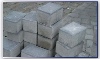
Calzadas laterales del "Leien" de Amberes (Bélgica) con adoquines porosos.
